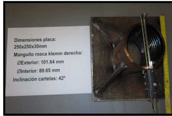
Fig 6. Cabeza de micropilote formada por un manguito y una placa soldada con cartelas.
