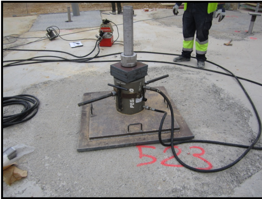
Fig 7. Ejemplo de ensayo a tracción.
