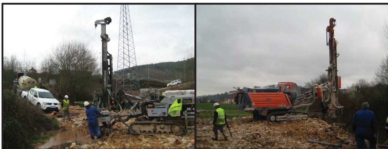
Fotografías de las perforadoras con martillo en cabeza (Comaccho MC600) y martillo en fondo (Titon 500), respectivamente.
